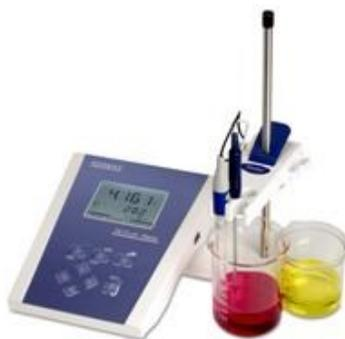
1. Retirer l'électrode de la solution de stockage des électrodes et la rincer à l'eau distillée. avec de l'eau distillée, sécher avec un tissu.
